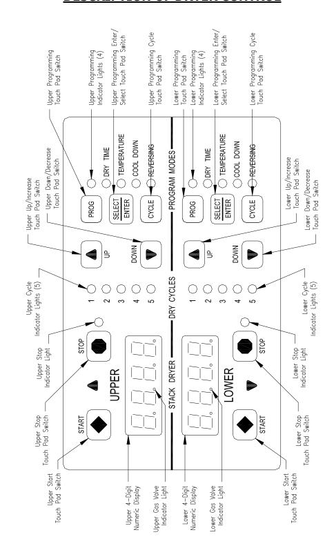
FIGURE 4: REVERSING DRYER CONTROL
